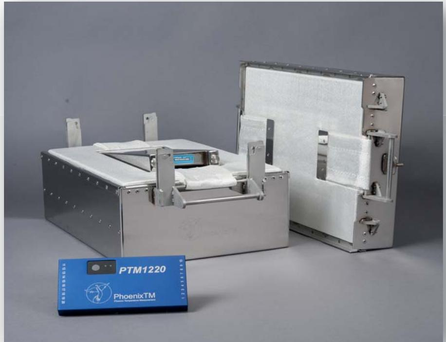
标准最大操作温度高达1000°C. 特定保温箱根据测量条件测量温度可高达1100°C.
